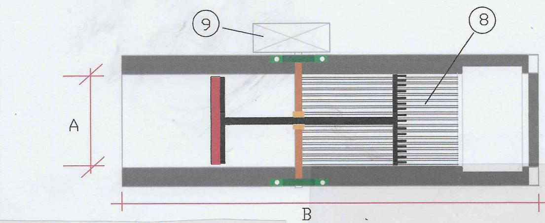
La griglia a pettine viene installata direttamente nel canale in cemento armato; il liquame passa attraverso la griglia curvata ad arco ed esce dalla parte opposta priva dei solidi. Questi restano nella parte anteriore della griglia e vengono poi eliminati mediante il braccio rotante che da una parte ha un pettine e dall'altra una spazzola, i quali mantengono pulita la parte filtrante. Il materiale eliminato viene depositato in apposita vaschetta estraibile.
